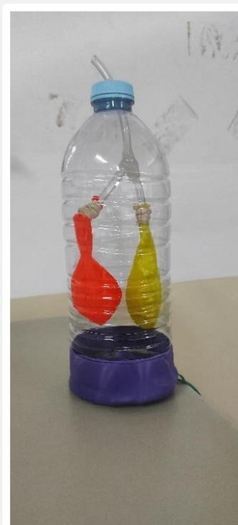
pressão diminui, formando uma diferença de pressão entre a parte de dentro da garrafa e a parte de fora. Portanto, assim como ocorre no sistema respiratório, a pressão atmosférica força o ar entrar e encher os balões. Em contrapartida, ao soltar a extremidade inferior, a diferença de pressão deixa de existir e, logo, o ar sai.
